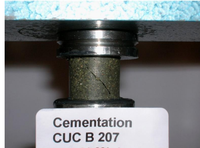
Cementering: Effekt av temperatur undersöktes på bentonitkutsar i enaxliga tryckförsök
