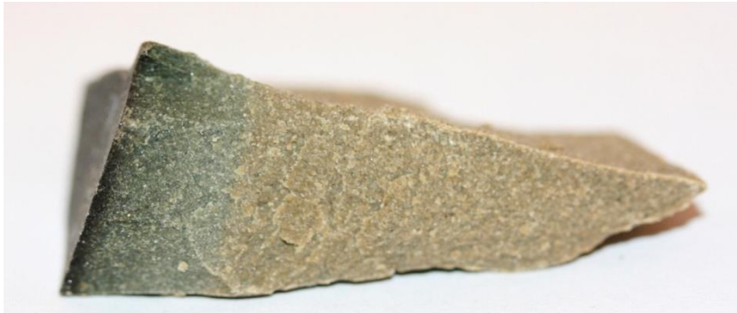
Reaktionszon mellan järn och bentonit (ABM-försöket, Äspö)
