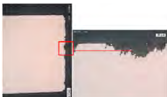
Figur 2. Omfattande kopparkorrosion och gropfrätning i FEBEX-försöket. Källa: "FEBEX-DP Metal Corrosion and Iron-Bentonite Interaction Studies, P. Wersin & F. Kober, NAB 16-16, Nagra October 2017.
