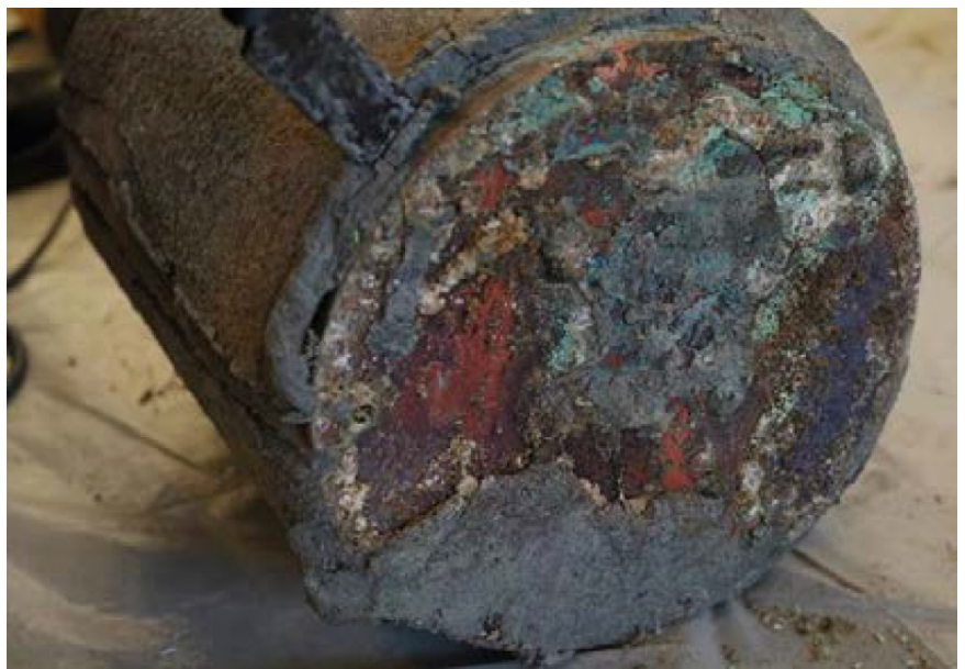
Korrosion på koppar (bottenplattan till LOT-försökspaket A3) efter 20 års exponering mot syrgasfritt grundvatten vid ungefär 80 graders temperatur. Bildkälla: SKB rapport -TR-20-14.
