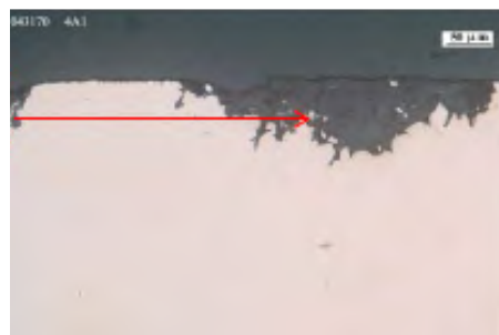
Gropfrätning i koppar, bild från FEBEX-rapporten, appendix B (beskuren).
